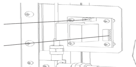
Figuur 4: Installatie van de relais printplaat en magneetklep op de 87D
